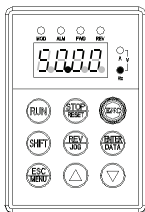
Fig.b waiting status, display waiting status parameter
